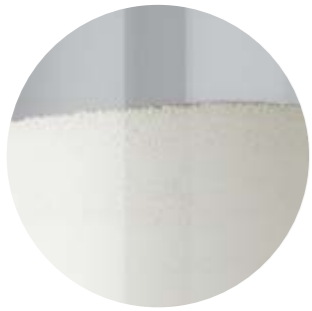
Pressgranulat hohle Körnchen, aus denen die Teller gedruckt werden
