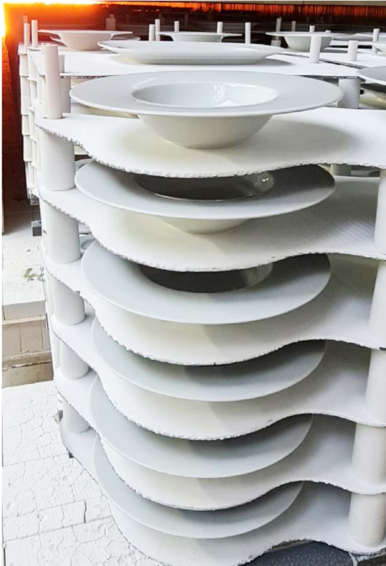
Endbrand bei einer Temperatur von 1400°C Final firing at a temperature of 1400°C
