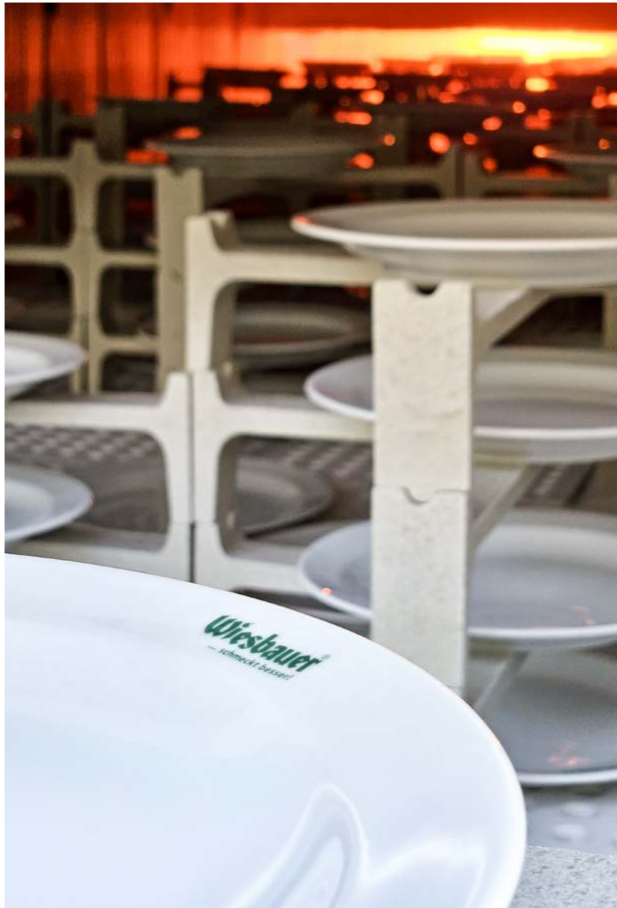
Dekorativer Brand bei einer Temperatur von 1250°C Decorative firing at a temperature of 1250°C
